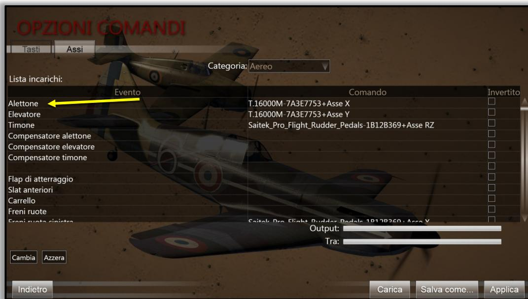
Alettone (nota freccia gialla) per controllare il rollio.
